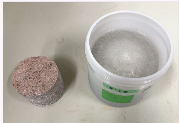
試験体を水浸させ、凍らせた状態で容器ごとCT撮影
