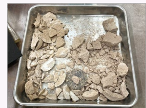
素材の土やセメントの配合を変えて実験を繰り返す
